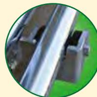
Die **Nylonrollen** unten ermöglichen ein leichtgängiges Verchieben bei hoher Stabilität
