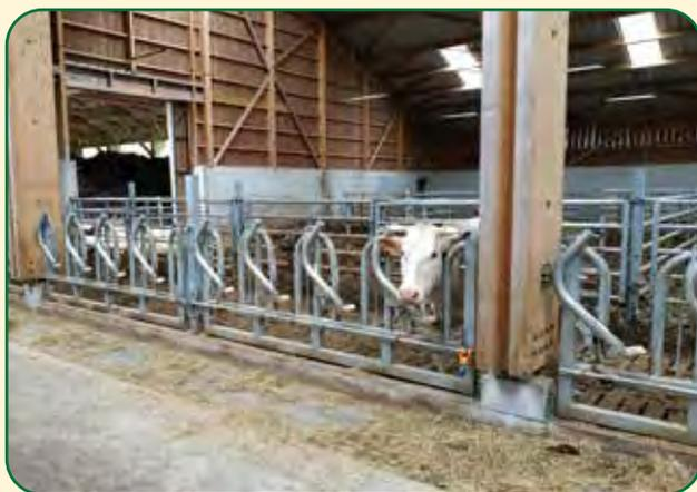
Besonders stabile Aufhängung. Vierkantführung stabilisiert den Drehpunkt des Fangbügels, dadurch wird der Verschleiß reduziert.
