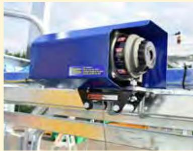
Elektrische Hinterfußwinde, bis 900kg,
