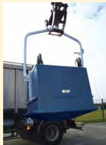
Kadaverwanne kann mit Hilfe eines Krans oder Traktors gehoben werden. Durch ein Seil kann der Kippmechanismus betätigt und so der Behälter einfach geleert werden.
