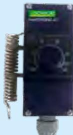
**Außen-Thermostat** Außenfühler zum automatischen Ein- & Ausschalten der Transformatoren bis max. 16A, 230V Montage erfolgt in der Zuleitung zu den Transformatoren Über ein Außen-Thermostat dürfen bis zu max. 20 Transformatoren 100W, max. 10 Transformatoren 200W oder max. 5 Transformatoren 400W gesteuert werden.
