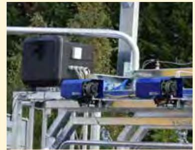
Elektr. Klauenpflegesatz: 2 Bauchgurte, 2 elektr. Winden, 1 Vorderfußwinde
