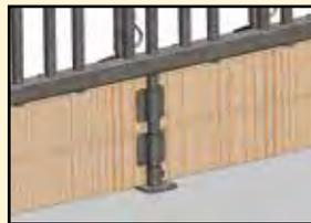
Abstützung für betonierte Barrenwand
