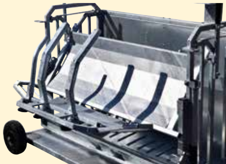
Praktikables Arbeiten durch komplettes Herauskippen aus der Behandlungsbox
