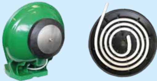
Spezielle Gummiaufnahme unten an der Tränke ermöglicht eine enge Wicklung des Heizkabels und hält damit auch das Restwasser frostfrei.
